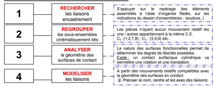
Tous les regroupements terminés, il devient possible d'établir le modèle du mécanisme. Celui-ci doit montrer les liaisons entre les différents groupes ou pièces par une représentation graphique qui forme la structure du mécanisme.
