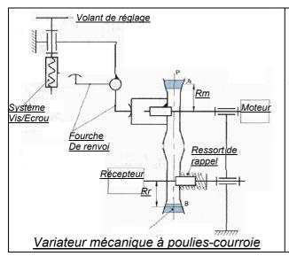
Par l'intermédiaire de la fourche de renvoi, l'action du volant de réglage provoque la variation de l'écartement entre les deux flasques de la poulie motrice.
