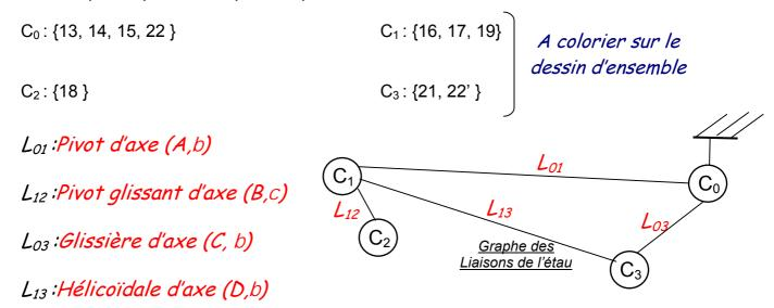
Remarque : dans le cadre d'une étude d'efforts, il est nécessaire de compléter le graphe en y ajoutant les actions créées par les éléments déformables ainsi que les actions à distance.
